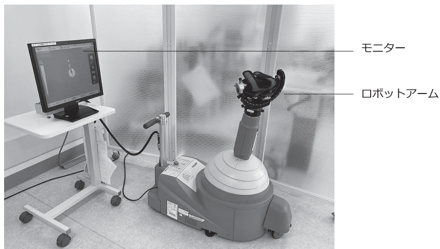
図1 上肢用ロボット型運動訓練装置 (ReoGo ® -J) ロボットアームに麻痺側上肢を固定し、画面上の課題に合わせてリーチ動作の訓練を行う。さまざまな難易度の練習課題の設定が可能である。
