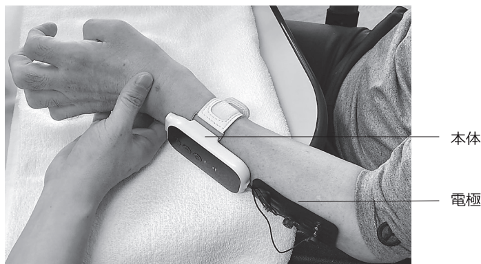
図5 装着式随意運動介助電気刺激 (WILMO ® )
